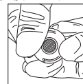
図2：ゴムスリットが開くことをボトル上面から確認します。
